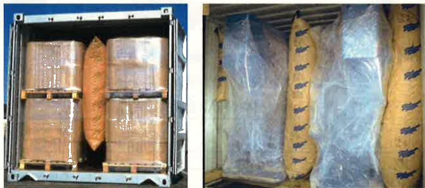
ダンナー用エアバックを使用した貨物の固定
